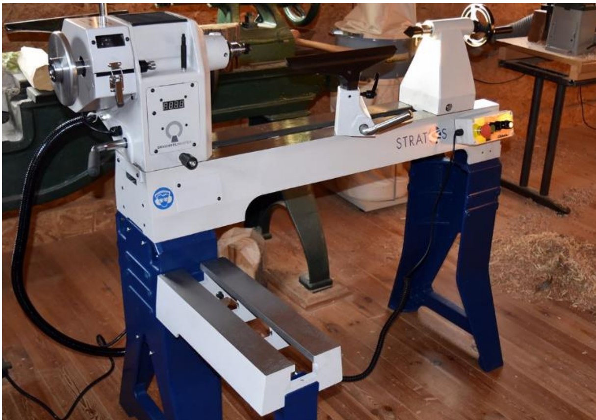
Rys. 7. Tokarki specjalne – tokarka do drewna
