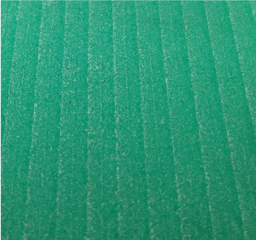
Rysunek 3: Przytopienie powierzchni materiału po frezowaniu
