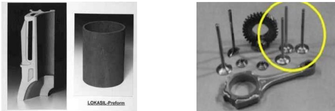
Rys. 10. Tuleje cylindrowe wykonane z kompozytu AlSi9Cu3 / preforma z 25%Si (Porsche Boxter) oraz zawory kompozytowe o osnowie Ti (Toyota Altezza).
