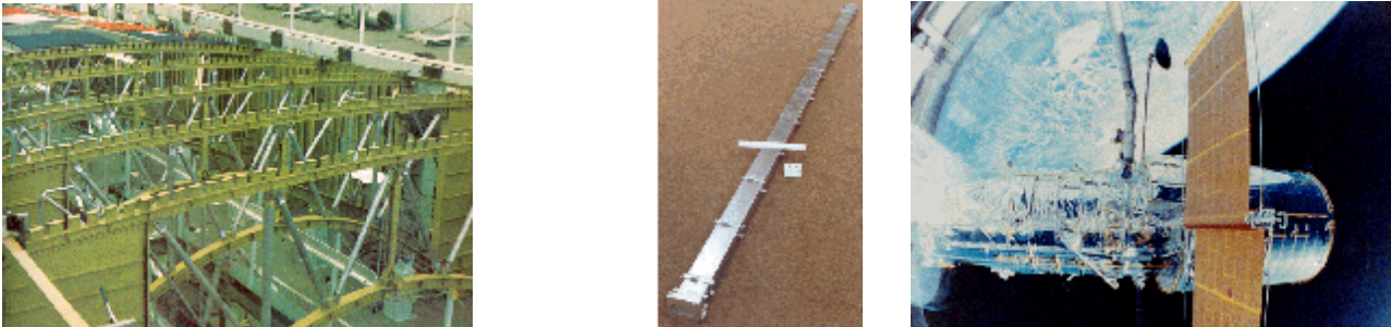
Rys. 8. Konstrukcja środkowej części kadłuba orbitalnego wahadłowca wykonana z rur Al/B – po lewej (Fot. U.S. Air Force/NASA). Wzmocnienie wysokiego wysięgnika anteny w Hubble Space Telescope (HST) wykonane z kompozytu P100/6061 Al, przed scaleniem z HST i zastosowane w HST z orbitalnym wahadłowcem na dolnej orbicie ziemskiej (po prawej).
