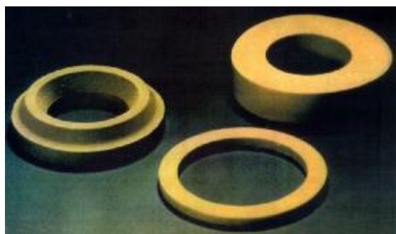
Rys. 2. Preformy ceramiczne zbrojące lokalnie kompozyty (tłok silnika) oraz mikrostruktura preformy z włókien SiC (b).
