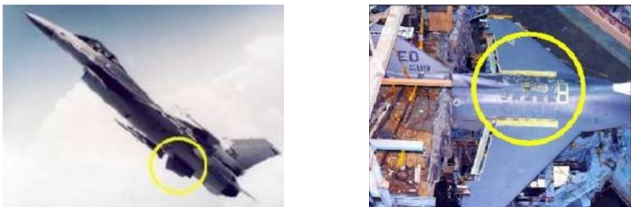
Rys. 9. Zastosowanie kompozytów w technice wojskowej na podkadłowe stateczniki kierunkowe (po lewej) oraz kłapy paliwowe (po prawej) samolotu F-16 wykonane z kompozytu 6092/17,5% SiC.
